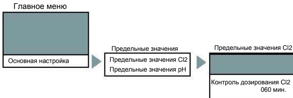
В позиции "Предельные значения" главного меню можно задать максимально возможное время, дозирования с полной производительностью. Если по истечении этого времени номинальное значение или зона пропорционального регулирования еще не достигнуты, и установленное управляющее воздействие (производительность дозирования) все еще находится на уровне 100%, срабатывает сигнализация тревоги, и соответствующий регулятор выключается.
