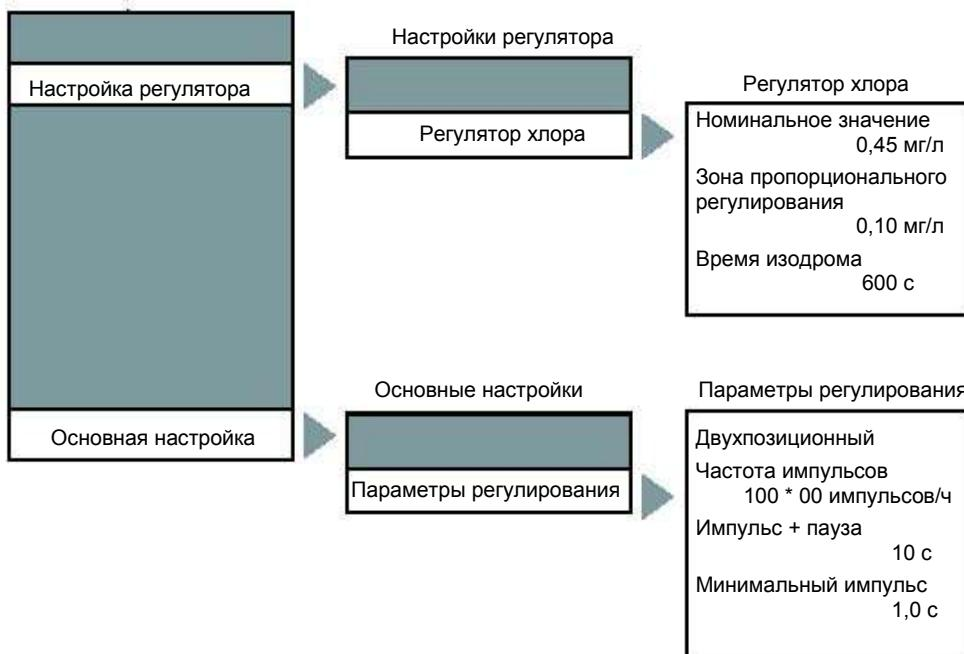
К регулятору хлора относится реле 2. Направление действия постоянно установлено на повышение.
