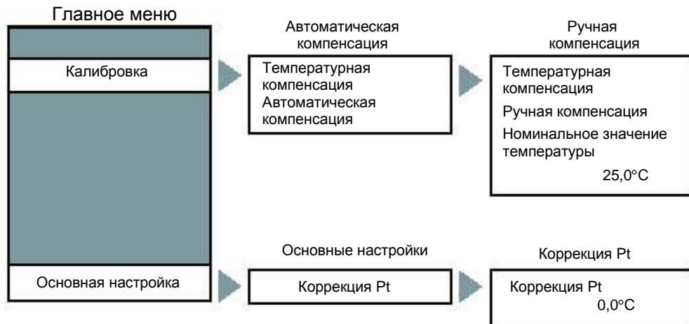
Возможен выбор между двумя видами температурной компенсации:
