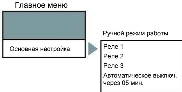
Реле 1 требуется только для управления электродвигателем. Реле 2 предназначено для регулятора хлора, а реле 3 - для регулятора pH.
