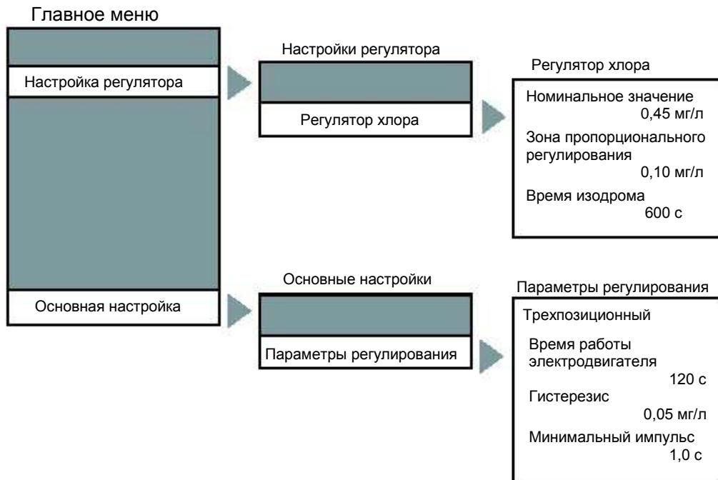
Для управления электродвигателем требуются два реле. Сюда относятся реле 1 = ВЫКЛЮЧЕНИЕ электродвигателя, реле 2 = ВКЛЮЧЕНИЕ электродвигателя. Они должны управлять пропорционально-интегральным регулятором.
