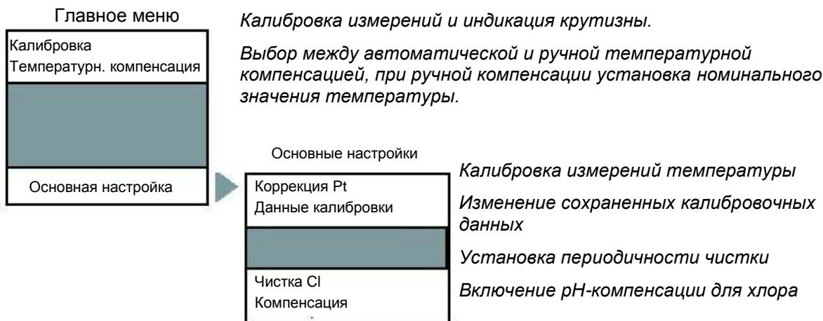
Для измерения сначала следует откалибровать измерения хлора и pH. В случае pH это производится путем обмера двух буферных растворов с известной величиной pH. В случае измерения хлора достаточно одноточечной калибровки:
