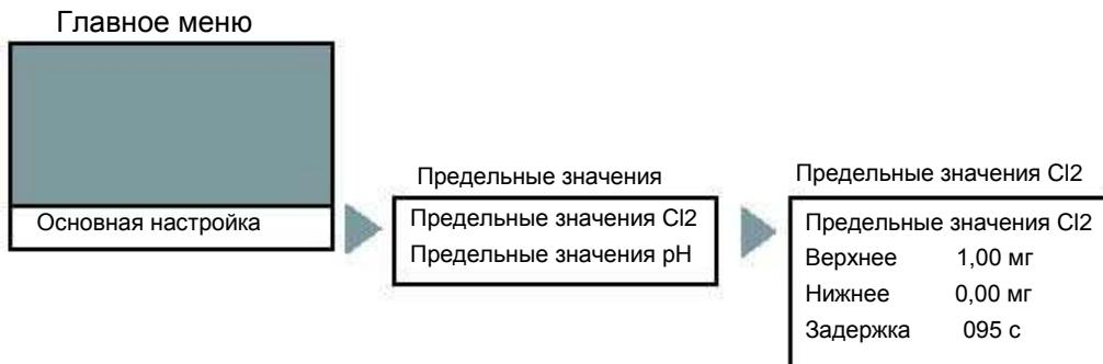
Для измерения хлора и для измерения pH можно установить верхнее и нижнее предельные значения.
