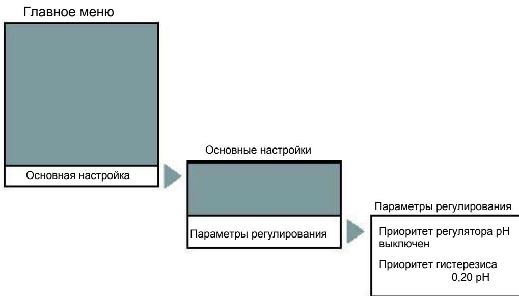
С помощью функции приоритета можно задержать регулятор хлора до тех пор, пока регулятор pH не будет отрегулирован.
