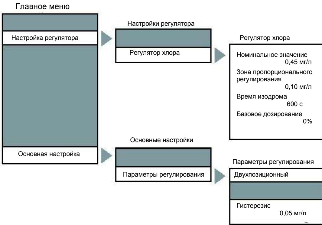
К регулятору хлора относится реле 2. Направление действия постоянно установлено на повышение.
