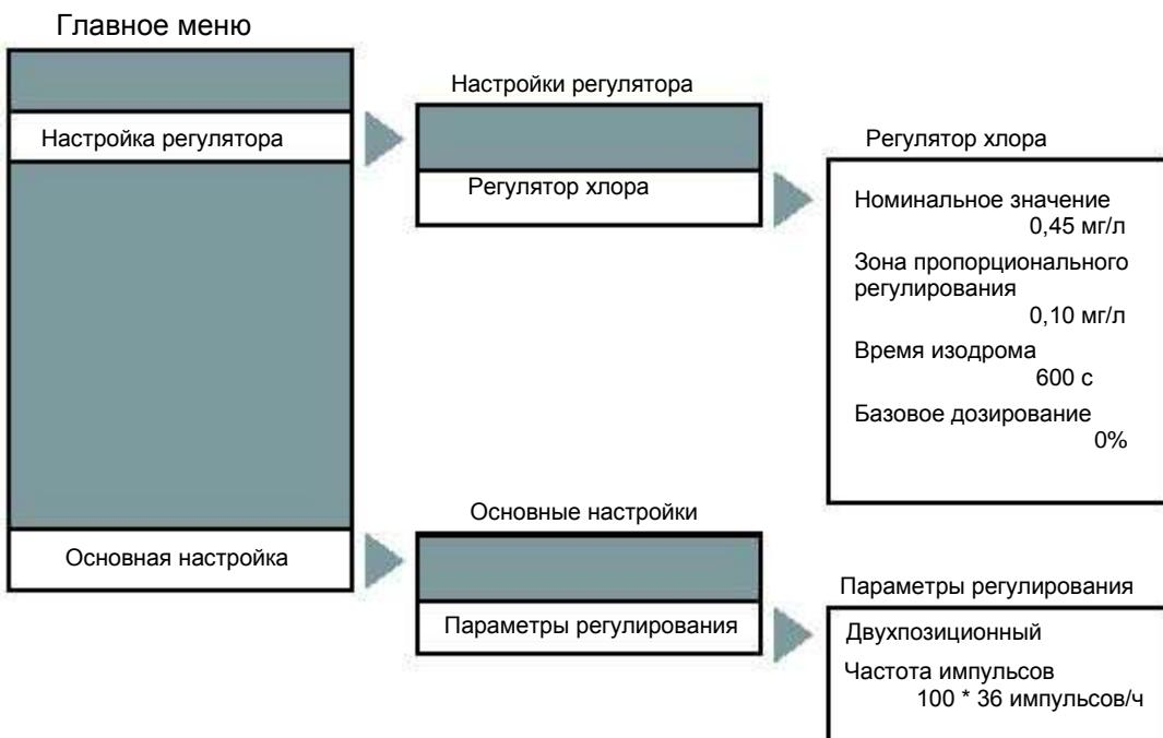
К регулятору хлора относится реле 2. Направление действия постоянно установлено на повышение.
