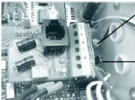
Винт распорного пальца выступает вверх через отверстие в интерфейсной плате.
