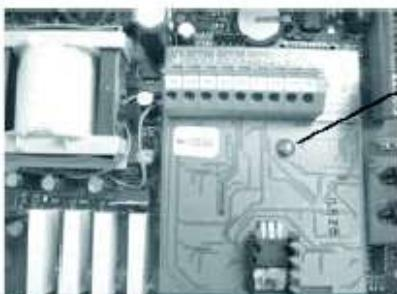
Винт распорного пальца выступает вверх через отверстие в плате для аналоговых выходов.
