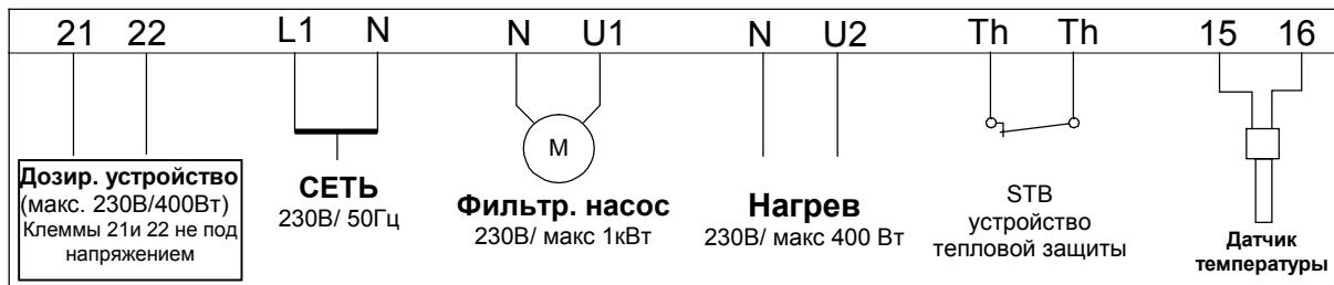
К контактам U2 и N можно вместо циркулирующего насоса теплоснабжения подсоединить дополнительный **OSI** блок с возможностью непосредственного подключения к нему электрических нагревательных элементов. В ассортименте имеются дополнительные блоки мощностью 10,5 кВт (Арт.№: 3002000100), 18 кВт (Арт.№: 3002400100) и 30 кВт (Арт.№: 3002100100)
