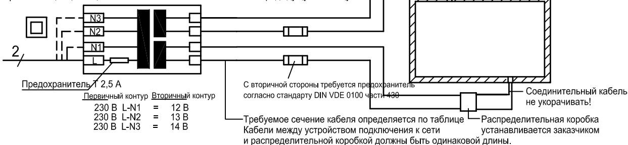
Прибор снабжен защитной изоляцией, поэтому защитное соединение (с заземлителем) не требуется!
