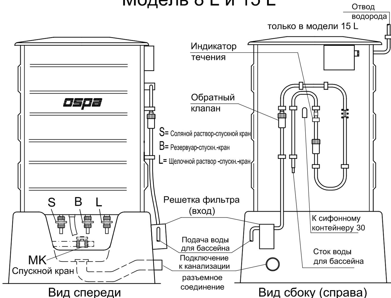
Отвод водорода хлорозонной установки 15 L устанавливается с восходящим уклоном 6% и выводится в свободное пространство
