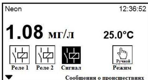
При данном виде меню отображаются реле, а также режим, в котором работает устройство. Если реле включено, то оно будет выделено, а на символе будет указано, замкнуто оно или разомкнуто. В качестве примера см. реле 3 на рисунке.
