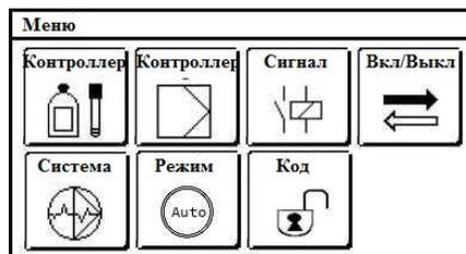
В автоматическом режиме контроллер включен и автоматически переключает реле и/или выходы тока, а также подключенные к ним исполнительные элементы. Доступ к аналоговым выходам и реле вручную через функцию проверки в данном режиме невозможен.
