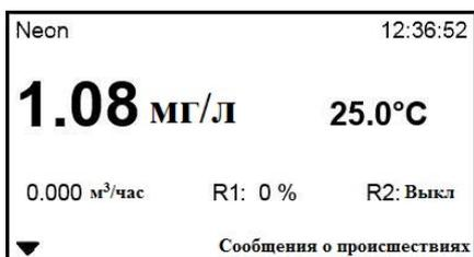
На рабочем столе рядом с измеряемой величиной и температурой будет отображаться значение потока, управляющий параметр в %, а также состояние реле 2, управляющего циркуляционным насосом.
