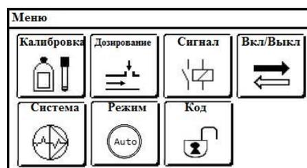
В автоматическом режиме дозирование включено и реле, также как и выходы тока, вместе с подключенными управляющими элементами переключаются автоматически. Доступ к аналоговым выходам и реле вручную через функцию проверки в данном случае невозможен.
