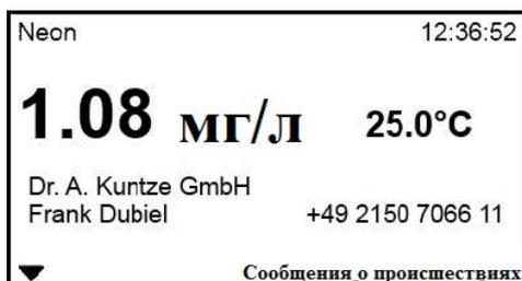
При данном виде меню дополнительно отображаются контактные данные, записанные в подменю СИСТЕМА => КОНТАКТНЫЕ ДАННЫЕ.
