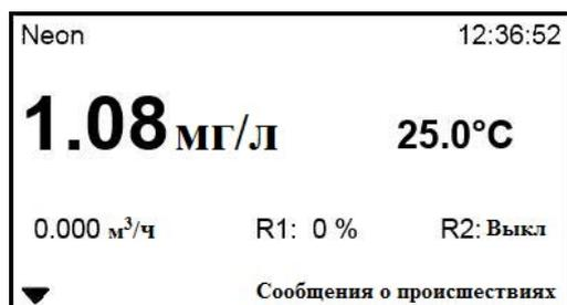
При данном виде меню отображается вычисленное значение потока, управляющий параметр и статус реле 2.
