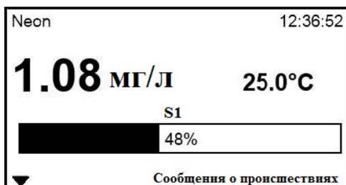
При данном виде меню в качестве полосы отображается управляющий параметр 1 или 2.
