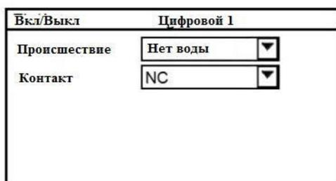
Установка Neon в своей базовой комплектации оснащена цифровым входом. Все настройки цифровых входов находятся в подменю ВКЛ/ВЫКЛ=>ЦИФРОВОЙ. Если активирован второй цифровой вход, то появится два символа.
