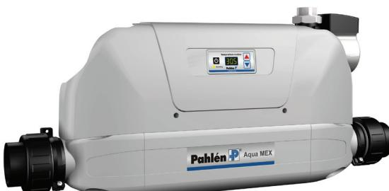
Теплообменник с электронным блоком управления потоком и температурой. Оборудован электронным датчиком потока, отключающим теплообменник в случае отсутствия потока воды. Высококачественный циркуляционный насос управляет движением воды в первичном контуре.
