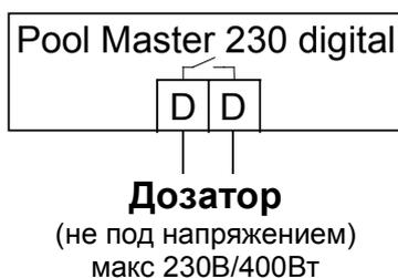
Между клеммами D-D внутри блока управления находятся нормально разомкнутые свободные от напряжения контакты реле. Которые, например, можно использовать для управления дозирующей техникой (во время фильтрации эти контакты замкнуты). Эти контакты допускается нагружать напряжением до 230В и током до 4А.
