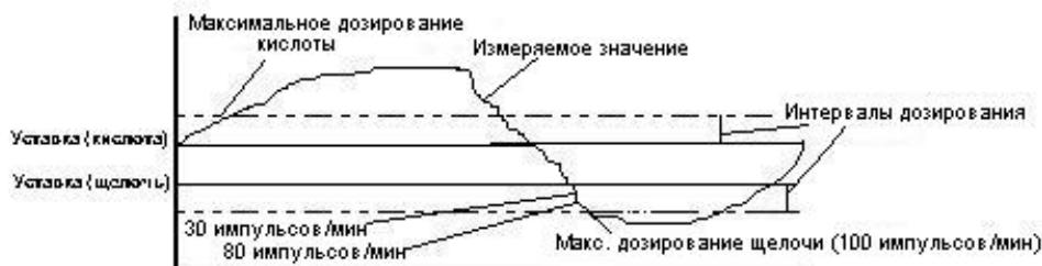
Интервал дозирования используется для управления работой дозирующего реле в случае существования разницы между измеренным значением и величиной уставки. Интервал дозирования выбирается в режиме настройки.
